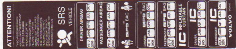
Nálepka umístěná na dveřním sloupku levých zadních dveří
