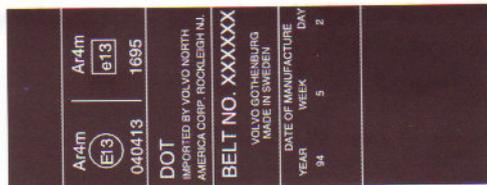
Nálepka na bezpečnostním pásu s předpínačem
