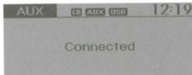
\* Režim AUX není možné spustit, pokud na pomocný vstup není připojené externí zařízení.
