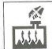
Nedemontujte vičko chladiče, dokud je motor nebo chladič horký. Ven může pod tlakem vystříknout horká chladicí kapalina a pára, a způsobit tak vážné poranění.
