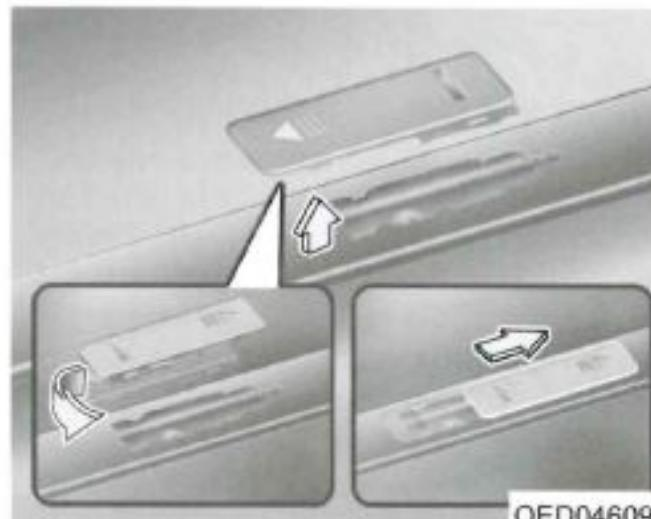
2. Otočte kryt o 180 stupňů a vložte kryt do otvoru na střeše, jak je znázorněno na obrázku.
