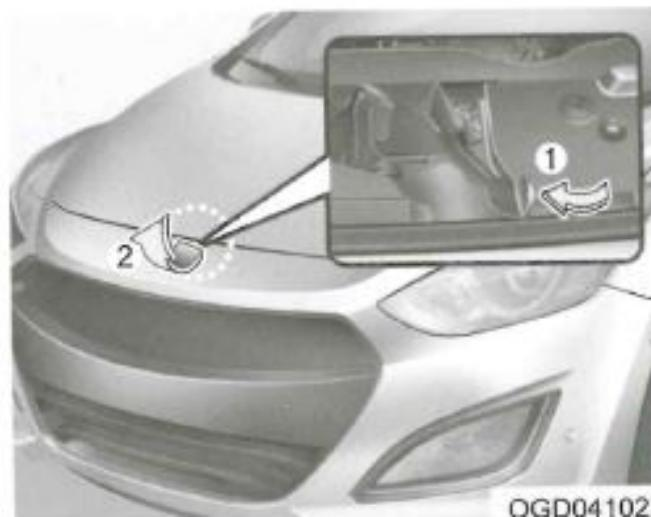
2. Přejděte k přední části vozu, mírně kapotu nadzvedněte, zatlačte na sekundární západku umístěnou uvnitř pod střední částí kapoty a kapotu zvedněte.
