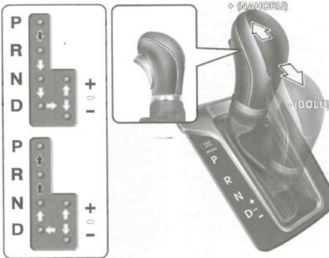
→ Při změně převodových stupňů se šlápněte pedál brzdy a stiskněte tlačítko uvolnění blokování.
