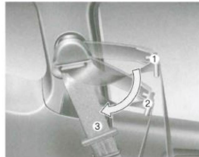
2. Nastavte rozšířené vodítko bezpečnostního pásu do polohy (3).
