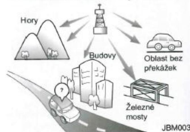
Vysílání v pásmu AM lze přijímat ve větších vzdálenostech než vysílání v pásmu FM. To proto, že rádiové vlny v pásmu AM jsou přenášeny na nízkých frekvencích. Tyto dlouhé nízkofrekvenční rádiové vlny jsou schopny kopírovat zakřivení zemského povrchu, aniž by unikaly do atmosféry. Kromě toho se ohýbají okolo překážek, takže poskytují lepší pokrytí signálem.
