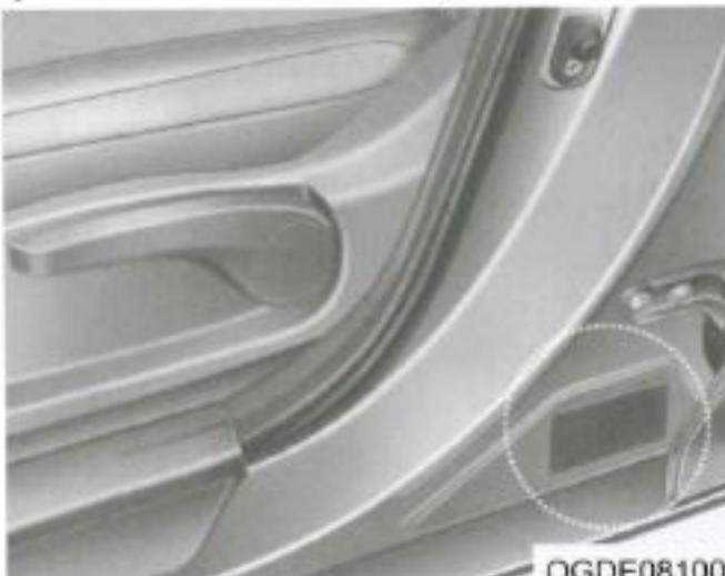
Štítek se značkou E se nachází na středním sloupku na straně řidiče. Tento štítek potvrzuje, že vozidlo splňuje předpisy ECE pro bezpečnost / ochranu životního prostředí. Obsahuje následující informace:
