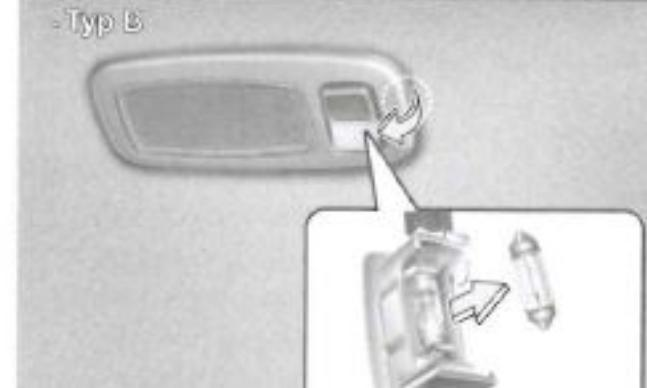
**Výměna žárovky vnitřního osvětlení**
