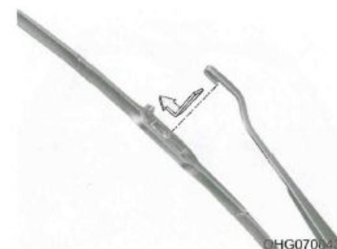
3. Při instalaci lišty stěrače provedte kroky uvedené pro její demontáž v opačném pořadí.
