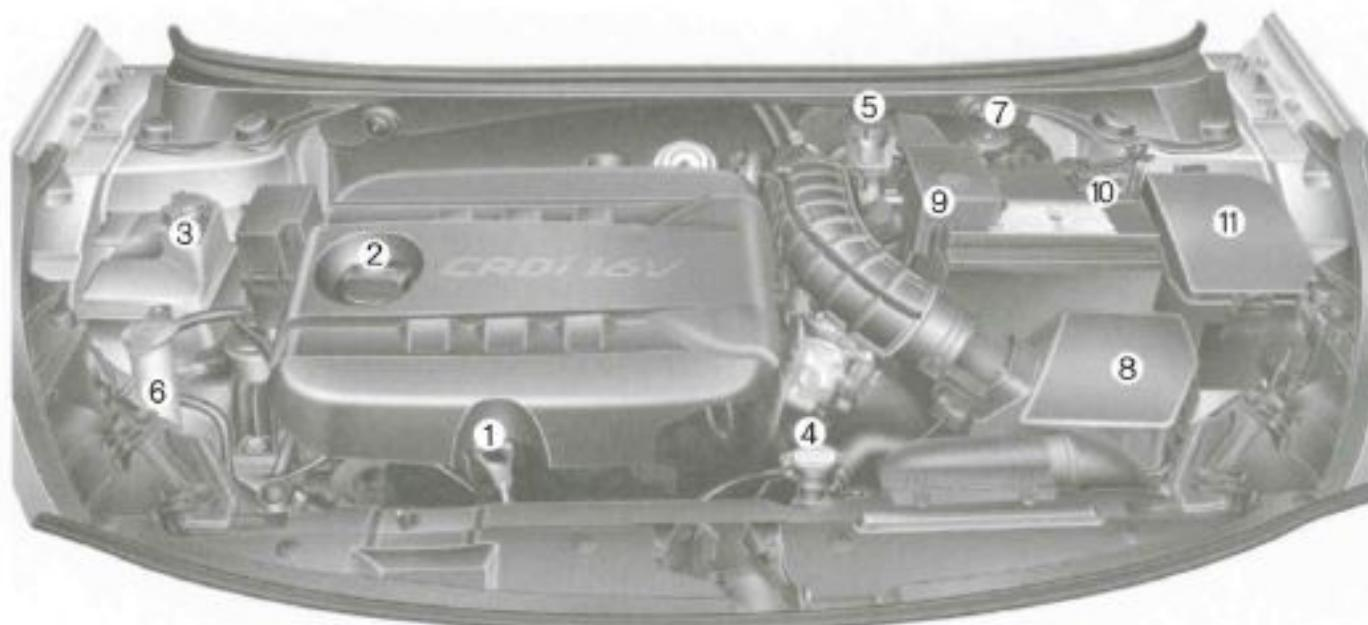
1. Měrka hladiny motorového oleje
