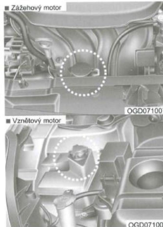
Zkontrolujte stav a spoje všech hadic chladicího systému a systému topení. Všechny zpuchřelé a popraskané hadice vyměňte.
