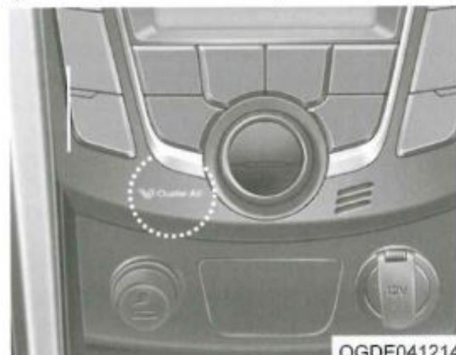
Když je spínač zapalování přepnut do polohy ON, funkce Čistý vzduch se zapne automaticky.
