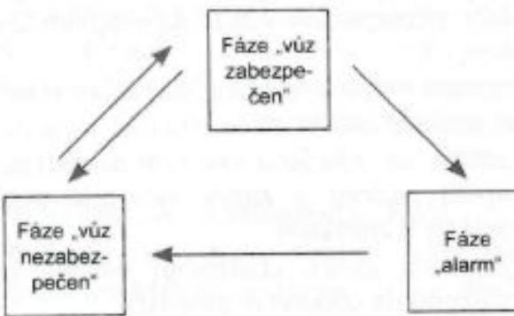
Tento systém je určen k ochraně vozidla proti neoprávněnému vniknutí. Tento systém pracuje ve třech fázích: první fáze je „vůz zabezpečen“, druhá fáze je „alarm“ a třetí je „vůz nezabezpečen“. Je-li systém aktivován, zajišťuje ochranu prostřednictvím poplašného signálu doprovázeného blikáním varovných blikáčů.
