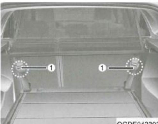
4. Upevněte popruhy pomocí nastavovacího prvku (1).
