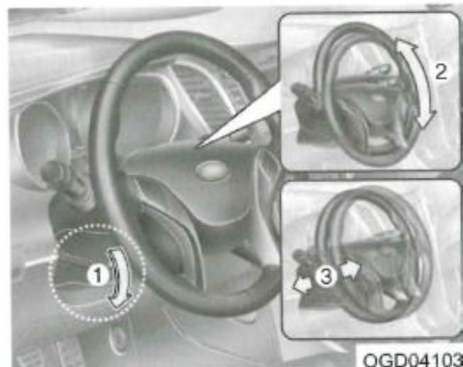
Pro změnu úhlu nastavení volantu stiskněte dolů (1) odjišťovací páčku, upravte nastavení volantu do požadovaného úhlu (2) a výšky (3), poté zatlačte páčku zpět nahoru pro zajištění volantu v dané poloze. Před jízdou se ujistěte, že je volant nastaven do požadované polohy.
