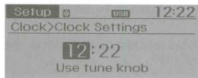
\* Úpravou zvýrazněného čísla nastavite [hodiny], pak stiskněte ovladač TUNE, abyste mohli nastavit [minuty].
