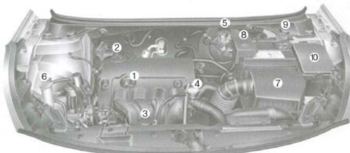
1. Měrka hladiny motorového oleje
