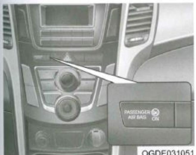
Indikátor zapnutí (ON) bezpečnostního vzduchového vaku spolujezdce
