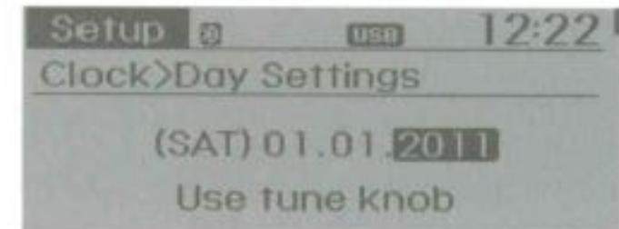
\* Otáčením ovladače nastavte zvýrazněný údaj, pak ovladač stiskněte, abyste se přesunuli na další údaj. (zadejte v pořadí den/měsíc/rok)
