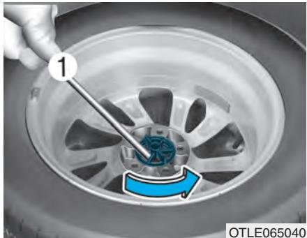
Pokud je obtížné povolit křídlový šroub připevňující pneumatiku rukou, můžete ho snadno povolit rukojetí zvedáku.
