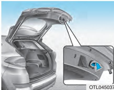
Sklopte a pevně zatlačte dveře zavazadlového prostoru. Ujistěte se, že dveře zavazadlového prostoru jsou řádně zajištěné.
