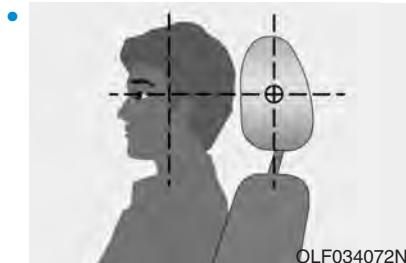
Nastavte opěrky tak, aby střední část opěrky byla ve stejné výšce, jako je výška horní části očí daného cestujícího.
