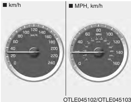
Rychloměr udává rychlosť vozidla a je kalibrován pro kilometry za hodinu (km/h) a/nebo míle za hodinu (MPH).
