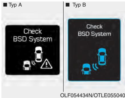
Pokud je problém se systémem BSD, zobrazí se varovné hlášení a rozsvítí se kontrolka ve spínači. Systém se automaticky vypne. Doporučujeme Vám nechat vozidlo zkontrolovat u autorizovaného opravce HYUNDAI.
