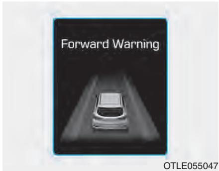
Varovné hlášení se zobrazí na LCD displeji a zazní výstražný alarm.
