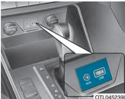
Vstup AUX můžete využít k připojení audiozařízení a vstup USB pro připojení zařízení USB nebo iPod®.
