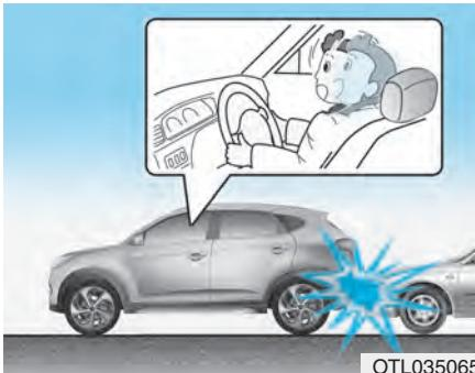
Čelní airbagy se nerozvinou při zadním nárazu, protože cestující se silou nárazu posouvají dozadu. V tomto případě by naplněné airbagy neposkytly další ochranný účinek.
