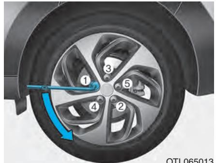
6. Uvolněte matice kola otáčením proti směru hodinových ručiček o jednu otáčku podle výše uvedeného pořadí, ale nesnímejte žádnou z nich, dokud není kolo zvednuté nad zem.
