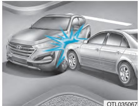
Čelní airbagy se nemusí rozvinout při bočním nárazu, protože cestující se pohybují směrem k nárazu, takže aktivace čelního airbagu by neznamenala zvýšení ochrany cestujících.
