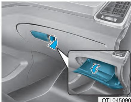
Pokud chcete příhrádku před spolujezdcem otevřít, zatáhněte za rukojeť a příhrádka se automaticky otevře. Po použití příhrádku před spolujezdcem zavřete.
