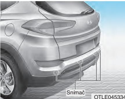
Zadní parkovací asistent pomáhá řidiči při couvání s vozidlem tím, že jej upozorní zvukovým signálem v případě, že je detekována překážka do vzdálenosti 120 cm za vozidlem.
