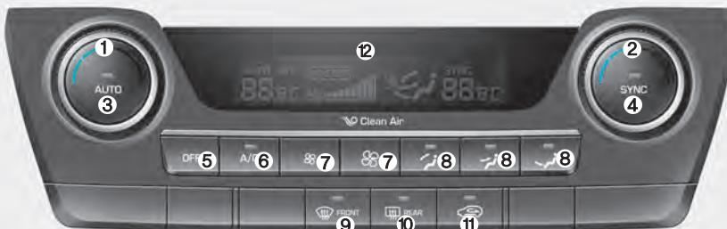
1. Ovladač pro nastavení teploty pro stranu řidiče
