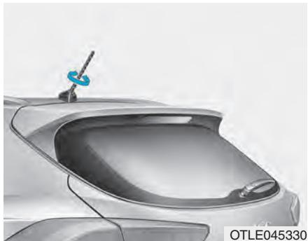
Střešní anténa přijímá radiové signály AM a FM. Pro demontáž otáčejte střešní anténou proti směru hodinových ručiček. Pro opětovnou montáž ji otáčejte po směru hodinových ručiček.
