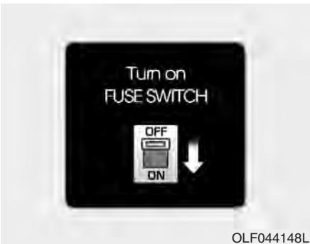
Pokud je pojistkový spínač v poloze OFF, zobrazí se výše uvedené hlášení.
