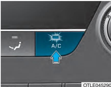
Pokud chcete klimatizaci zapnout, stiskněte tlačítko A/C (kontrolka se rozsvítí). Opětovným stisknutím tlačítka klimatizaci vypnete.
