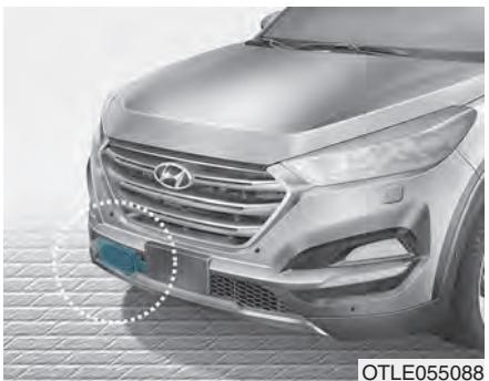
Snímač je určen k zachování určité vzdálenosti od vozidla jedoucího vpředu. Nicméně objektiv snímače znečištěný cizími předměty jako sníh a déšť, činnost AEB se dočasně vypne. V takovém případě varuje řidiče varovné hlášení. Nejedná se o průruchu AEB. Pro obnovení činnosti systému AEB odstraňte cizí předměty. Dokonce může dočasně vypnout AEB. Vždy udržujte objektiv snímače čistý.
