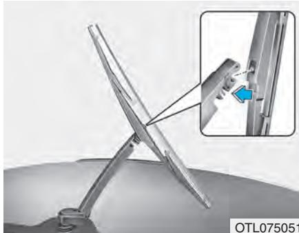
2. Nainstalujte novou lištu zasunutím středové části do otvoru v rameni stírače, dokud se nezajistí.
