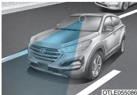
Když systém detekuje, že vozidlo výjízdí z pruhu, upozorní řidiče vizuálním a zvukovým znamením a zároveň vyvine mírný protitlak na volant, a pokusí se tak zabránit vyjetí vozidla z jízdního pruhu.
