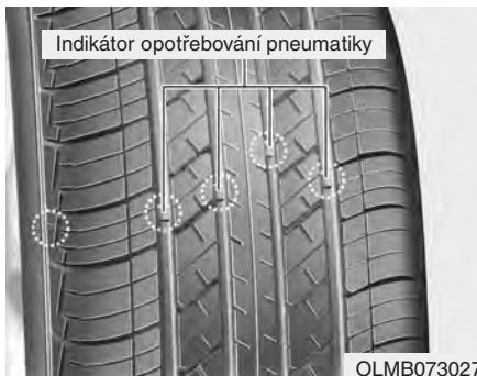
Pokud je pneumatika rovnoměrně opotřebována, indikátor opotřebení pneumatiky se objeví ve formě souvislého pásu napříč vzorkem. Upozorňuje na to, že na běhoune zbývá méně než 1,6 mm vzorku. Pokud k tomu dojde, pneumatiku vyměňte.
