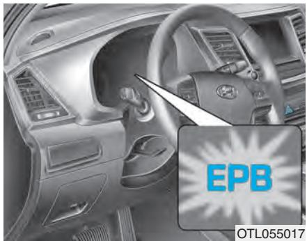
Kontrolka poruchy EPB zůstane rozsvícená, rozsvítí se za jízdy nebo se nerozsvítí, když se změní poloha tlačítka start/stop motoru na ON. To indikuje, že se může jednat o poruchu EPB.
