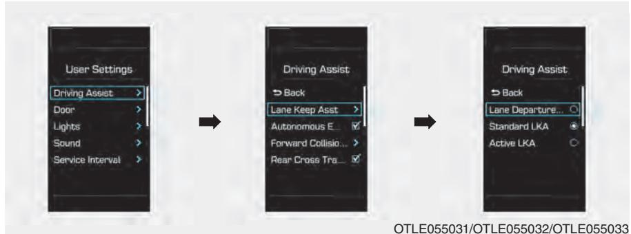
Řidič může LKAS změnit na LDWS nebo měnit režim LKAS na standardní LKA a aktivní LKA prostřednictvím režimu Uživatelská nastavení na LCD displeji. Systém je automaticky nastaven na standardní LKA, pokud není zvolena jiná funkce.
