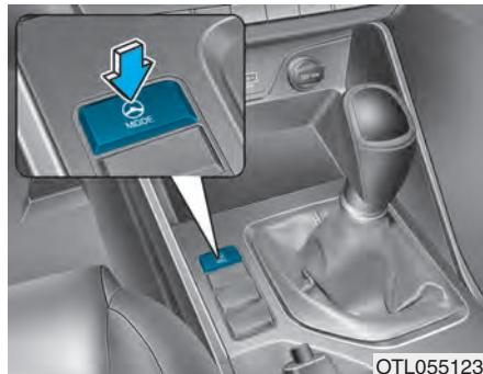
Flexibilní řízení řídí úsilí při řízení dle preferencí řidiče a silničních podmínek.
