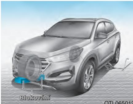
5. Zablokujte přední a zadní pneumatiku šikmo naproti pneumatice, kterou měníte.
