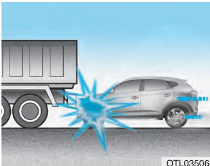
Před nárazem řidič často prudce brzdí. Takové prudké brzdění snižuje přední část vozidla, takže vozidlo může vjet pod vozidlo s větší světlou výškou. Při tomto podjetí se airbagy nemusí naplnit, protože zpomalení detekované snímači může být při tomto podjetí výrazně nižší.
