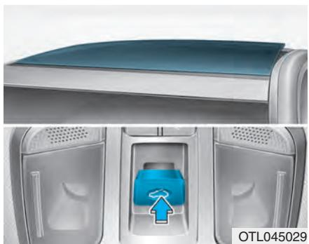
Když zatlačíte ovládací páčku střešního okna nahoru, sluneční clona se otevře a poté se vyklopí střešní okno.
