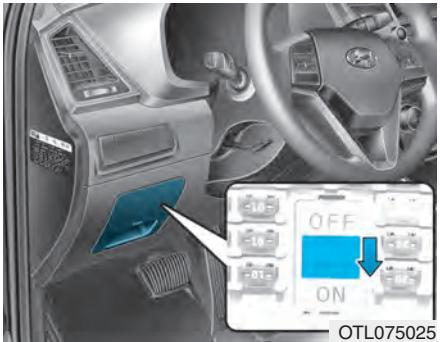
Pojistkový spínač mějte vždy přepnuty do polohy ON.
