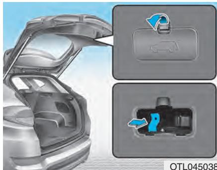
Vaše vozidlo je vybaveno páčkou nouzového bezpečnostního uvolnění dveří ve spodní části dveří zavazadlového prostoru. Když někdo zůstane nedopatřením zamknutý v zavazadlovém prostoru, lze dveře otevřít následujícím způsobem:
