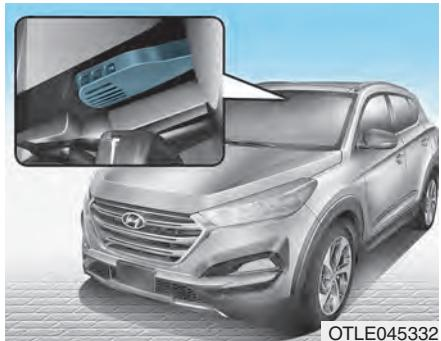
Automatické odmlžování snižuje možnost vnitřního zamlžování oken a automaticky snímá vlhkost na okně.
