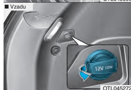
Elektrická zásuvka je určena pro napájení mobilních telefonů a jiných zařízení určených pro provoz na napájení z elektrického systému vozu. Příkon zařízení nesmí překročit 180 W při běžícím motoru.
