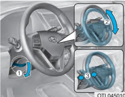
Zatlačte zajišťovací/uvolňovací páčku (1) na sloupek řízení dolů a nastavte úhel (2) a polohu (3) volantu. Umístěte volant tak, aby směroval k Vaši hrudi, nikoliv k obličeji. Ujistěte se, že vidíte varovné kontrolky a měrky přístrojové desky.
