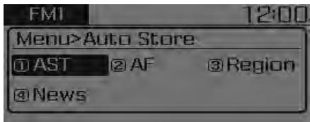
Zvolte AST (Auto Store) pro ukládání frekvencí s maximální kvalitou příjmu do předvoleb **1** ~ **6**. Pokud nejsou přijímány žádné frekvence, pak bude vysílána naposledy přijatá frekvence.
