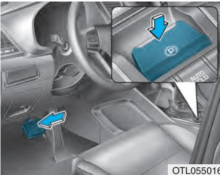
Pro uvolnění elektronické parkovací brzdy uvolněte ovladač EPB za následujících podmínek:
