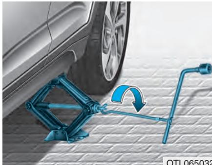
8. Kliku zvedáku vložte do zvedáku, otáčeje jí doprava a zvedejte vozidlo, dokud se pneumatika nezvedne nad zem. Ujistěte se, že vozidlo stojí na zvedáku stabilně.
