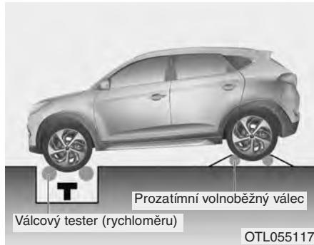
Vozidlo s permanentním 4WD nelze testovat na válcovém stavu 2WD. Pokud musíte použít zařízení pro vozidla 2WD, použijte následující postup:
