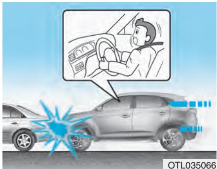
Při určitých srážkách při pomalé rychlosti se airbagy nemusí rozvinout. Airbagy jsou navrženy tak, aby se v podobných případech nerozvinyly, protože by nezvýšily ochranný účinek bezpečnostních pásů.
