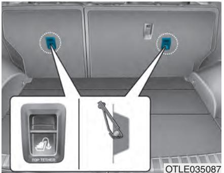
Závěsné držáky pro dětský zádržný systém jsou umístěny v zadní části opěradel.
