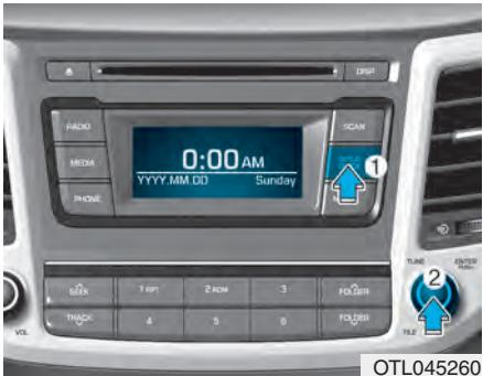
Hodiny musíte nastavit, pokud dojde k odpojení akumulátoru nebo vyjmoutí příslušné pojistky.
