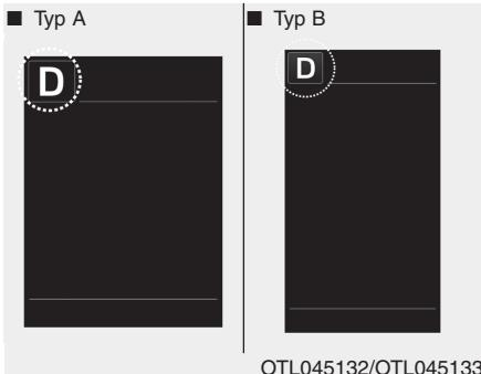
Tento indikátor zobrazuje, která poloha řadicí páky automatické převodovky je zvolena.
