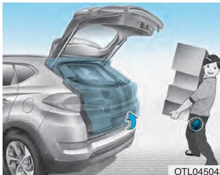
Je-li vozidlo vybaveno chytrým klíčem, dveře zavazadlového prostoru lze otevřít bez dotyku pomocí systému chytrých dveří.
