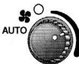
Ovladač zadního ventilátoru, který se nachází na stropě blízko středu vozidla má polohy "VYPNUTO", "AUTO" a mnoho různých rychlostí ventilátoru.
